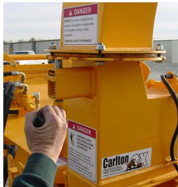
**ALWAYS MAKE SURE THE DISCHARGE IS POINTED IN A CLEAR DIRECTION FOR DISCHARGE OF CHIPS.**
