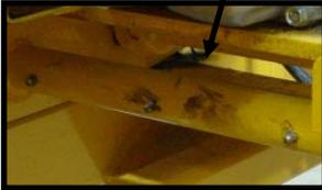
ENGINE SLIDE GREASE FITTING (6 PLACES-3 EACH SIDE)
