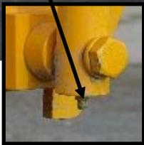
FEED CONTROL BAR GREASE FITTING
