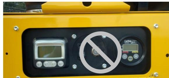
**DANGER: MAKE SURE THE IGNITION KEY HAS BEEN REMOVED AND MACHINE CAN'T BE STARTED BEFORE SERVICING ANY PART OF THE CHIPPER.**
