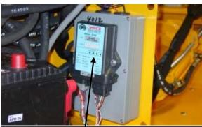
COMPARE THE LIGHT CONFIGURATION ON THE RECEIVER TO THE DIAGNOSTIC CHART IN THE RADIO CONTROL MANUAL
