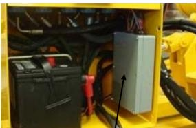
REMOVE THE COVER ON THE REMOTE RECEIVER AND DRILL HOLES TO ATTACH THE RADIO RECEIVER
