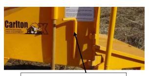
STORED POSITION OF LOCK PINS; ONE ON EACH SIDE OF INFEED CHUTE
