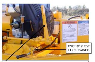
ENGAGEMENT HANDLE SHOULD BE PULLED ALL THE WAY BACK TO THIS POSITION TO ENGAGE THE CUTTER DISK
