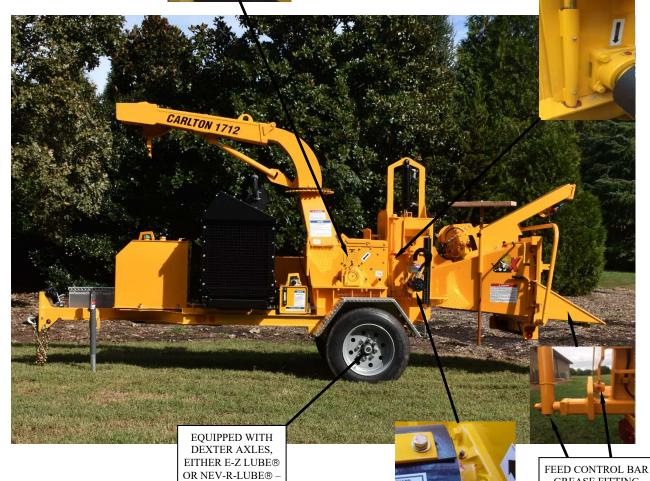
FEED WHEEL BEARING GREASE FITTING \* 1 PUMP OF GREASE DAILY ON EACH BEARING
