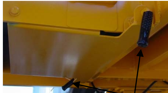
CLEAN-OUT DOOR HANDLES
